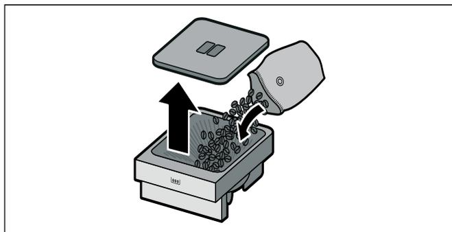
**Указание:** Глазированные, карамелизованные или обработанные другими содержащими сахар добавками кофейные зерна приводят к забивке заварочного блока. Используйте только смеси кофейных зерен, предназначенные для полностью автоматической кофемашины.
